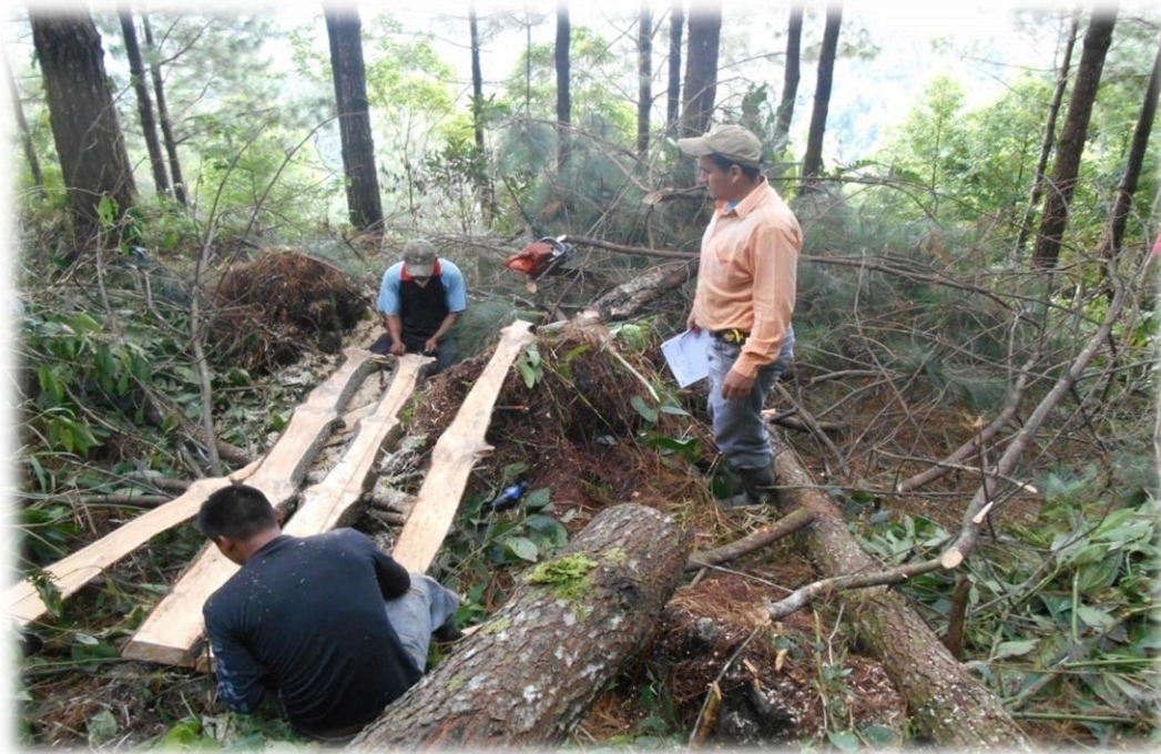
Figura No. 14 Proceso de escuadrado y dimensionado de las reglas de pinus maximinoi , por personal contratado en la finca pampacche de San Cristóbal A. V.
